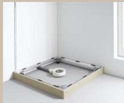
При выверке положения поможет вспомогательный шаблон для укладки плитки, который служит меткой для будущей верхней кромки. Положение рамы фиксируется, и производится монтаж вспомогательной обшивки, которая входит в комплект поставки. Таким образом, достигается фиксация по месту с миллиметровой точности, с возможностью заливки раствора до краев. Можно забыть о раздражении, вызванном неточностью расположения гнезд.
