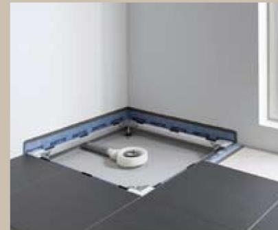
Вспомогательные шаблоны для укладки плитки укладываются в любом положении, затем производится облицовка пола и стен плиткой. Вспомогательные шаблоны для укладки плитки помогут плиточнику добиться точного совмещения при работе. При этом не требуется вначале монтировать душевой поддон.
