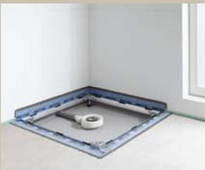
Уплотнение из нетканого материала приклеивается к раме, уплотнение стыка с конструкциями здания производится с помощью уплотнительной супензии. Дополнительно на уплотнительный нетканый материал вокруг рамы укладывается уплотнительная ПЭ-лента.
